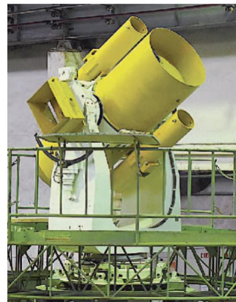
Опорно-поворотное устройство для телескопов.
