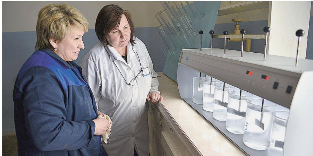
**КАЧЕСТВО ВОДЫ ПОД КОНТРОЛЕМ!** Аппаратчик химводоочистки Вероника Ботова и инженер-технолог Светлана Ананьева определяют режим смешения реагентов на флокуляторе.
